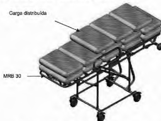
Fig.01 – Esboço do teste de compressão da Maca Retrátil.
