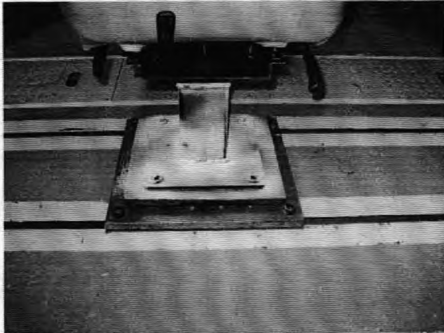
FOTO 6 – DETALHE DA BASE DE FIXAÇÃO E PARAFUSOS ANTES DO ENSAIO.
