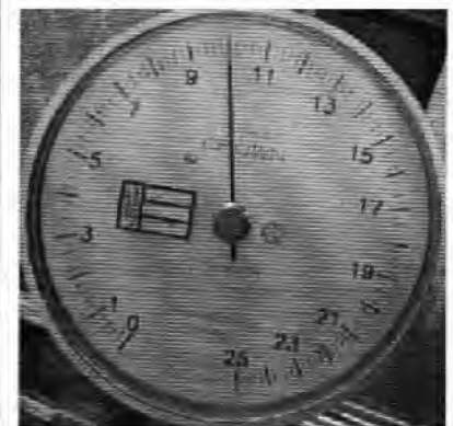
Fig.27- Dinamômetro indicando a medida de 1000 kgf.
