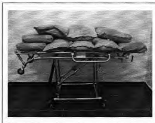
Fig.09 – Visão lateral da maca com carga distribuída de 300 kgf.
