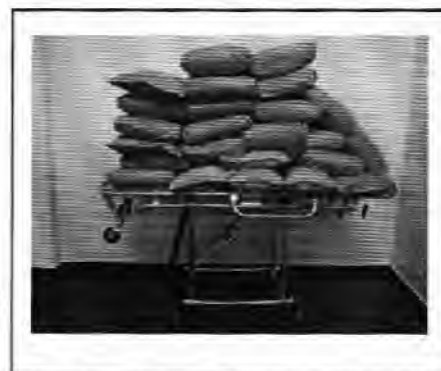
Fig.12 – Detalhe do carrinho com carga de 600 kgf.
