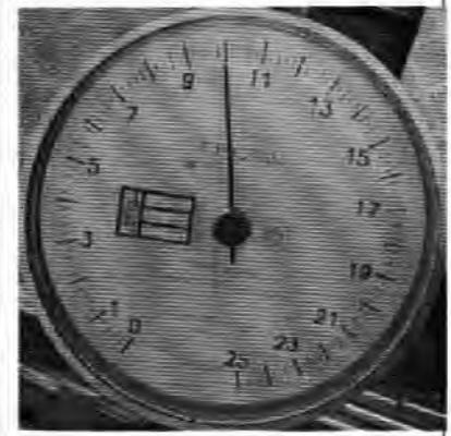
Fig.24 – Dinamômetro indicando a carga de 1000 kgf.
