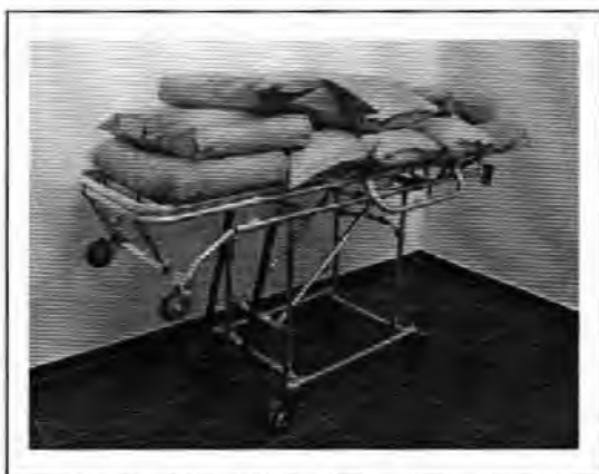
Fig.08 – Visão isométrica da maca com carga distribuída de 300 kgf.
